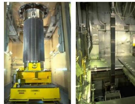
Cellule de déchargement des assemblages
